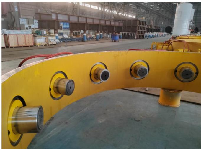
图 2-15-2 夹桩器液压缸及卡爪伸出状态
