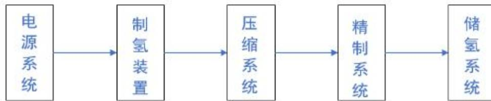
图 2-1-1 “标准单元模组”制氢装置
