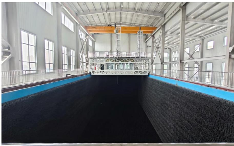
图 2-22-4 基于六面消声水池的水下声呐计量装置
