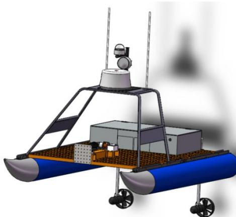
图 2-7-5 无人船载水下自动升降装置安装位置示意图
