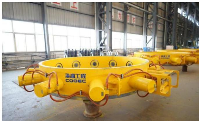
图 2-15-1 风电用大型导管架裙桩夹桩器
